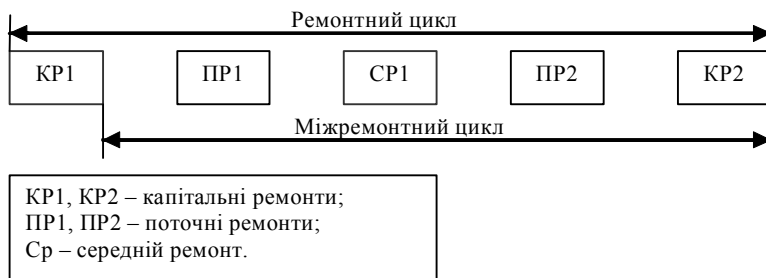
Рисунок 3.3 – Ремонтний цикл агрегату
