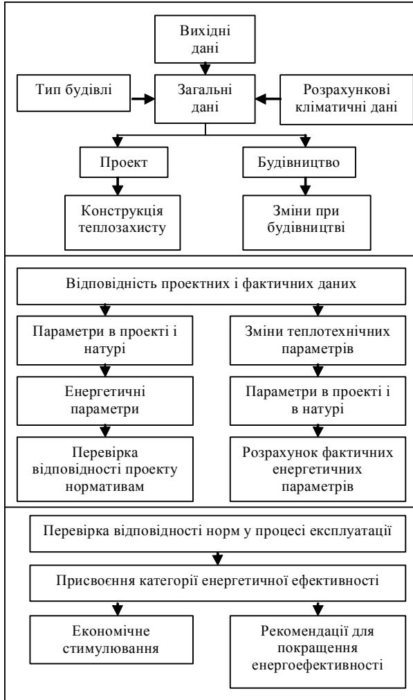
Рисунок 6.1. – Загальна структура типового енергетичного паспорту будівлі
